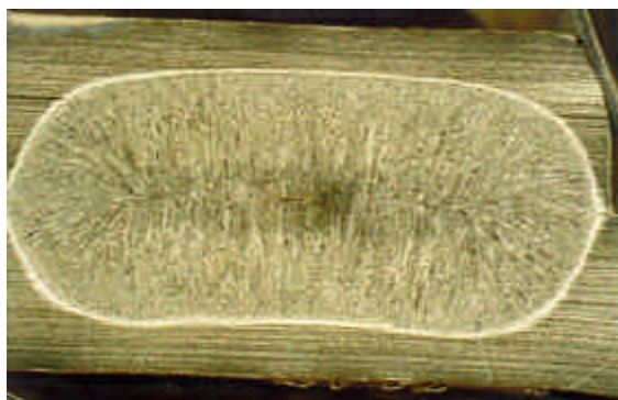
Fig. 18 - Sezione metallografica di un punto di saldatura. Materiale AISI 301 LN, spessore 2 mm.
