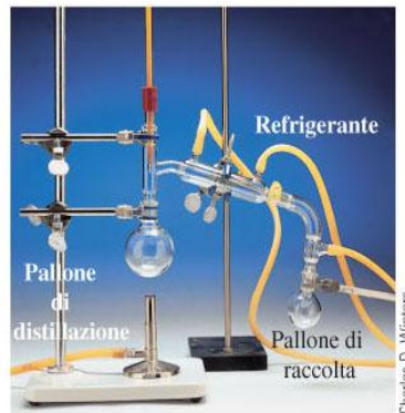
Figura 13-14 Apparecchio per la distillazione in laboratorio. Durante la distillazione di un liquido non puro, le sostanze non volatili rimangono nel pallone di distillazione. Il liquido vaporizza e poi condensa prima di arrivare nel pallone di raccolta. Se il campione contiene sostanze infiammabili è pericoloso usare delle fiamme libere per scaldarlo. In questi casi è preferibile usare un'altra fonte di calore, come ad esempio una piastra elettrica.
