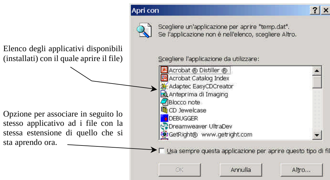
Finestra che appare se si prova ad aprire un file a cui non è associato nessun applicativo.
