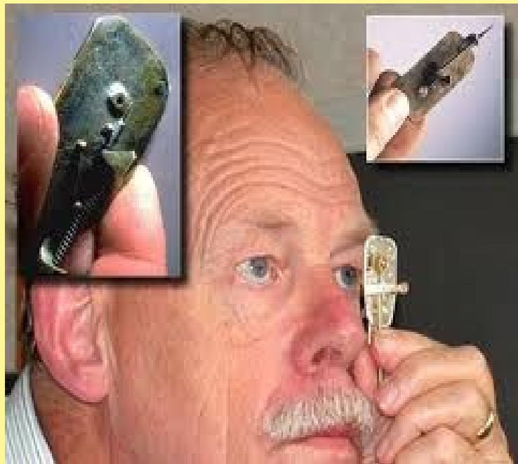
Modo d'impiego del microscopio di Van Leeuwenhoek
